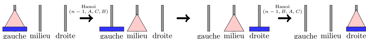
FIGURE 3 – Représentation schématique de l’algorithme récursif dans le cas de n > 1 disques. Les triangles roses représentent des tours de n - 1 disques.
